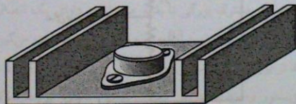
شکل ۱۲-۲۷: نمایش یک ترانزیستور قدرت نصب شده بر روی یک گرماخور
