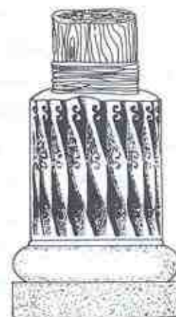
تصویر ۱۰۲ - ستونی در خزانه، بر پایه ی دیرکی از چوب شاخه های باریک را می پیچانند و سپس روی آن را با گل اندود می کردند. روی این ستون ها با رنگ های آبی و سرخ تند و رنگ سفید نقاشی شده بود.
